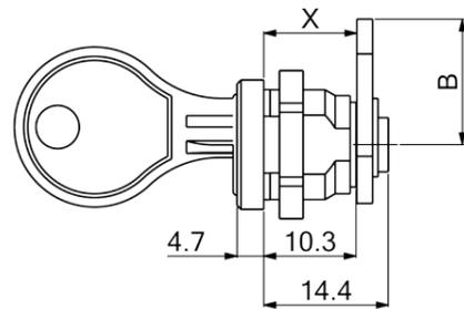
Размер монтажного отверстия
