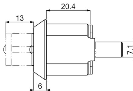
Размер монтажного отверстия
