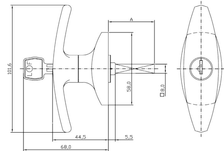
Размер монтажного отверстия
