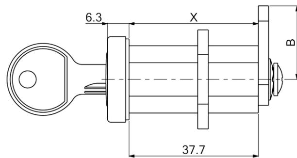
Размер монтажного отверстия
