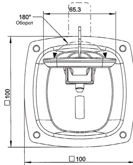
Размер монтажного отверстия
