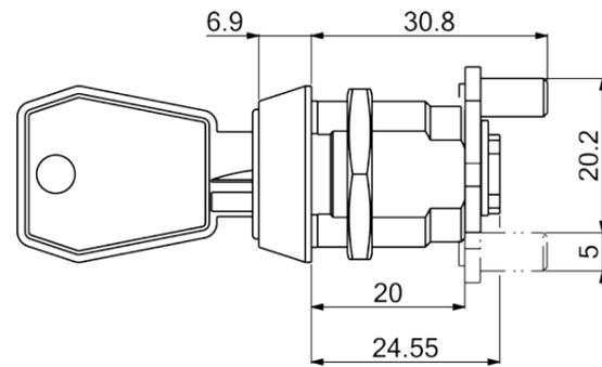
Размер монтажного отверстия
