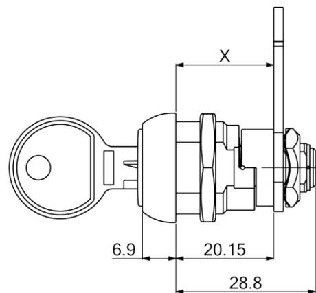
Размер монтажного отверстия
