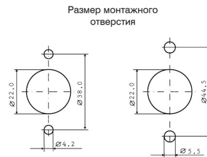
Размер монтажного отверстия
