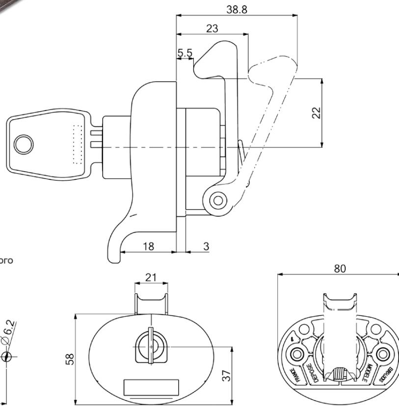
Размер монтажного отверстия
