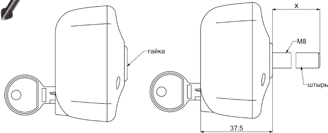
B578 (гайка М8)/B669 (гайка М6)
